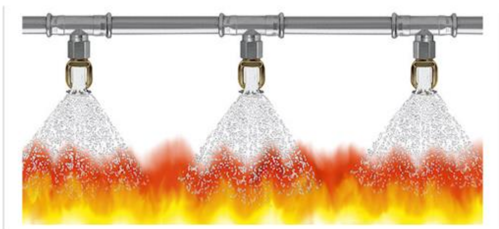
Рисунок 5 – Дренчерные установки для пожаротушения
